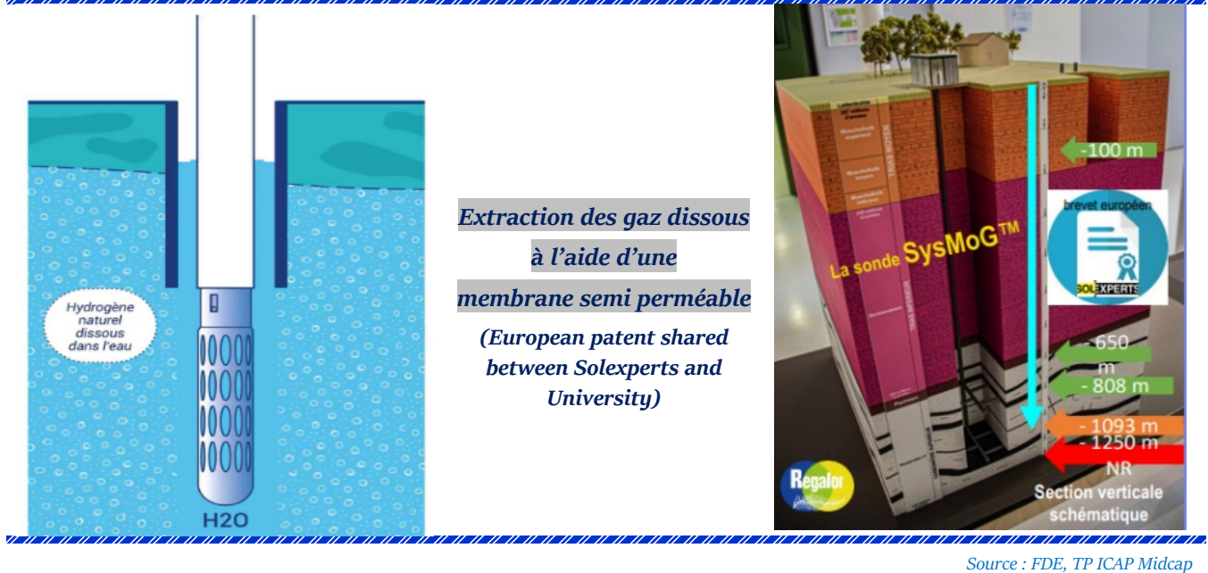
Fig. : Un nouvel outil unique au monde pour la mesure des gaz en forage
